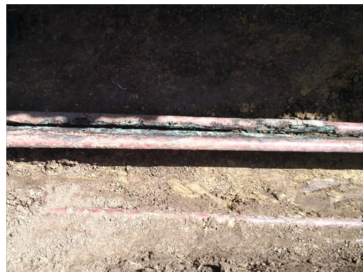
Slika 3- oštećenja na plaštu koji je u eksploataciji preko 30 godina
